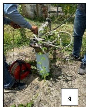
รูปที่ 5.2.4-6 การวัดระดับน้ำใต้ดินจากบ่อบาดาลบริเวณพื้นที่โครงการประตุระบายน้ำท่านางงาม จังหวัดพิษณุโลก ในช่วงเดือนกรกฎาคม 2567 (ฤดูฝน)
